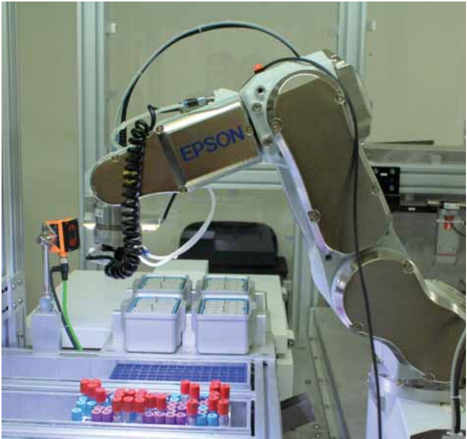
Celda de automatización con robot para el sector médico.
