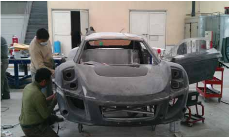
Ensamble manual del auto Mastretta.
