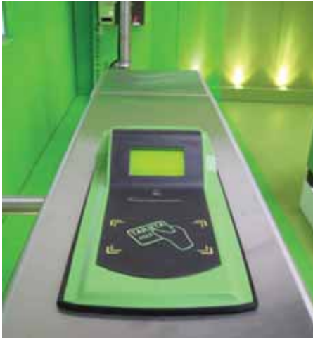
Torniquete controlado mediante tarjeta inteligente.
