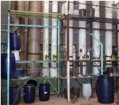
Prototipo y pruebas de lixiviación con ácido clorhídrico.
